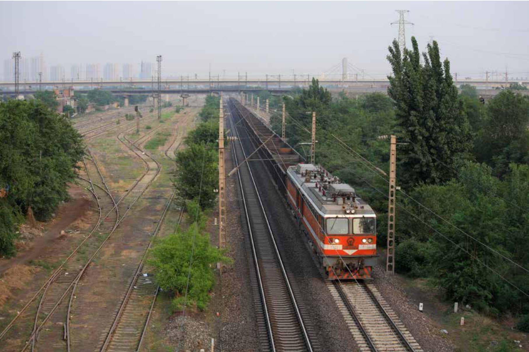
▼ Lokomotywa serii 8K ze składem pustych węglarek zostawia za sobą centrum zatłoczonego Pekinu. Ten dwuczłonowy elektrowóz o łącznej mocy 6400 kW jest jednym ze 150 egzemplarzy wyprodukowanych dla kolei chińskich.
