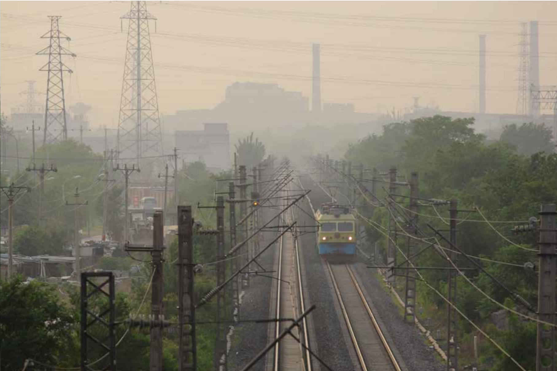
▼ Skład z kruszywem prowadzony przez lokomotywę SS4. Produkowana w latach 1985–2003 osiąga moc 6400 kW. Jest to jeden ze 158 egzemplarzy.
